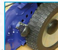
**Regulación de altura central** mediante una palanca, pudiendo regular de 20-65 mm.
