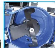
**Cuchillas de alta ventilación** de serie para garantizar un alto flujo de aire y recogida, aún en condiciones de hierba húmeda.
