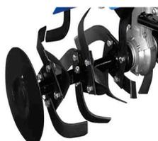
**Fresas reforzadas con eje hexagonal.**
