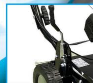
Regulación de altura centralizado mediante una palanca, pudiendo regular de 20-70mm.
